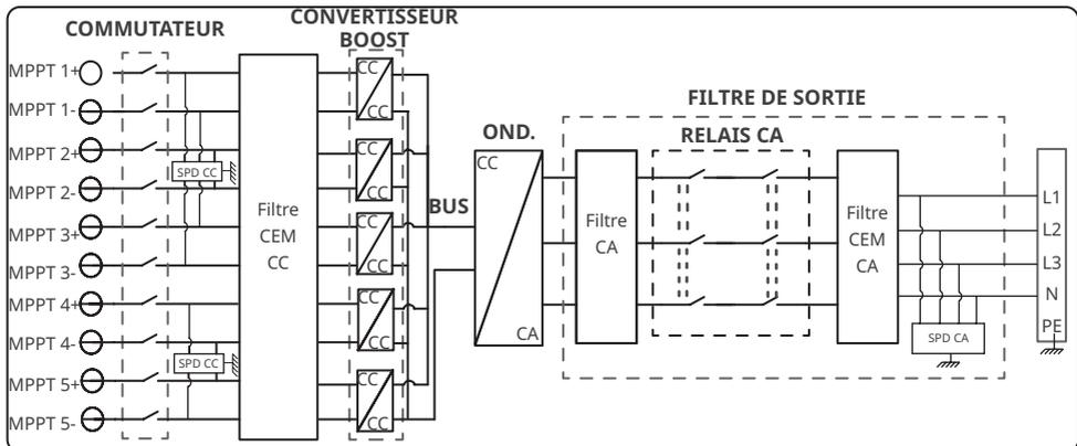
Le schéma électrique des modèles GW60KS-MT, GW60KS-MT-EU et GW35KLS-MT est le suivant.
