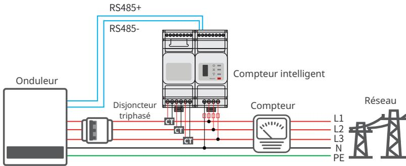
**Scénario de mise en réseau avec limite de puissance (plusieurs onduleurs)**
