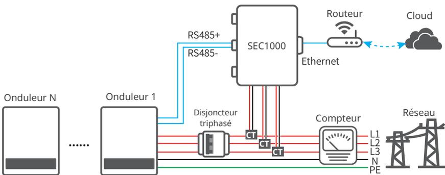
Après avoir réalisé les connexions des câbles, définissez les paramètres associés via l'application LCD ou SolarGo pour permettre d'exporter le contrôle de la limite de puissance ou le contrôle de la limite de puissance de sortie.
